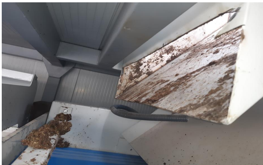
Rys. 3. Dolna część leja załadunkowego.
