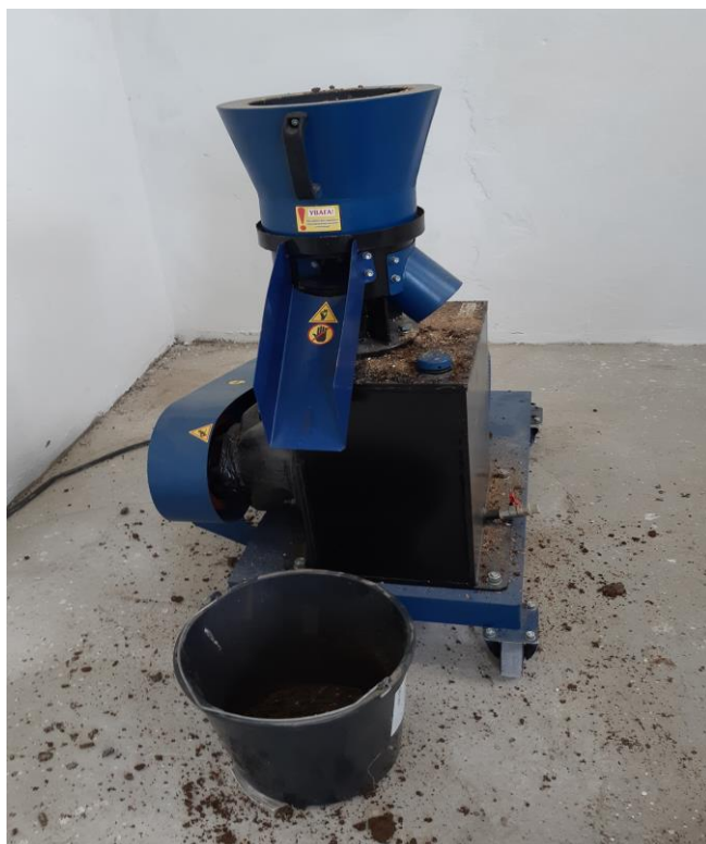
Rys. 5. Peleciarka PRIME-200 w trakcie pracy.
